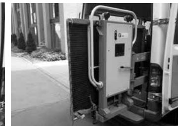
Der Schwenklift wird zwei Mal gedreht, dann ausgeklappt und auf den Boden gelassen. Der Fahrgast kann von der Seite einsteigen.
